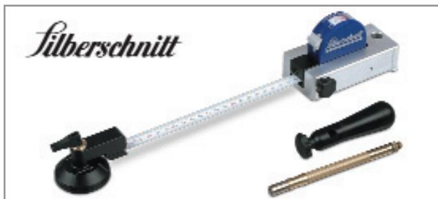
Это устройство сэкономит Ваше время на изготовлении многочисленных шаблонов. Диапазон резки радиусом от 16 до 300 см. В поставку входит масляный стеклорез 2000.S Стандарт с углом заточки режущего ролика 145° и поперечная ручка для стеклореза.
