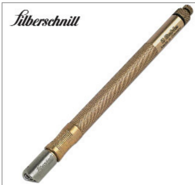
Режущий ролик изготовлен из высококачественного материала Torlife. Двухуровневый клапан обеспечивает оптимальную подачу жидкости для резки, что гарантирует идеальный результат резки. Стеклорез имеет массивную латунную рукоятку и круглую режущую головку со сменным режущим роликом.
