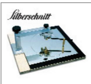
При помощи этого инструмента вы сможете вырезать круги диаметром до 34 см, а также эллипсы от 2,5 до 40 см с максимальной разницей между диаметрами 8 см. Новая, усовершенствованная модель позволяет настраивать инструмент на ту толщину стекла, с которой Вы работаете.
