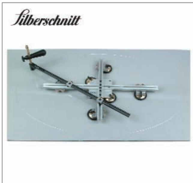
Система Зильбершнитт 2000 для вырезки кругов и эллипсов. Вырезка с точностью до миллиметра от 22 до 122 см или от 9" до 48" стекла толщиной до 19 мм. Минимальный диаметр 6 см. В комплект входит масляный стеклорез 2000.S Стандарт, поперечная ручка для стеклореза, захват JOVO для ломки стекла 705.0, жидкость для резки, 2 фломастера с адаптером. Всё это поставляется в практичном алюминиевом чемодане.
