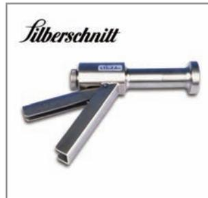
Цельнометаллический вскрыватель вырезов массивной конструкции. Работает по принципу бойка. Регулировка ударной силы. Для контролируемого разлома и получения ровной кромки стекла даже в сложных случаях.
