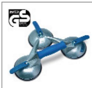
Для переноски различных грузов, современных и крепких материалов, высокая прочность достигается благодаря тому, что присоска изготовлена из алюминия со вставкой из пластмассы - все это отличительные признаки этой присоски. Ее можно использовать для транспортировки таких материалов, как стекло, пластмасса, металл, обработанное дерево и мрамор. Знаки безопасности TUV/ GS. Подъемный вес 100 кг, для горизонтальной переноски грузов.
