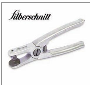
Для работ по технологиям Тиффани и осуществления других художественных замыслов. Для стекла толщиной до 5 мм. Поваричивающаяся давящая пластина. Разлом осуществляется точно по срезу и без осколков. Подходит для внутренних вырезов и узких полос стекла. Давящие балка и пластина заменяются.
