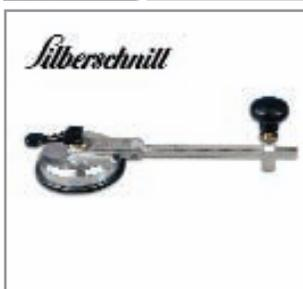
Стеклорез массивной конструкции предназначен специально для проведения вырезки кругов. Высокая функциональная надежность достигается за счет прочности этой модели. Поворачивающаяся ручка над держателем режущего ролика обеспечивает передачу большого давления. Для работы со стеклом толщиной от 10 до 25 мм.
