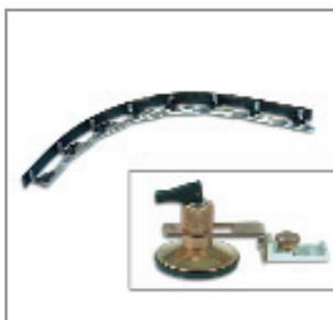
Для выполнения фигурных вырезов на стекле. Лучший помощник при проведении замеров дверей и окон с арками. Измерение как внутренних, так и внешних арок. Изготовлено из гибкого металла. Ширина 40 мм. Закрепляется на стекле с помощью присоски ВО 670.5 (заказывается отдельно)
