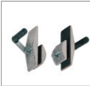
Подходит для транспортировки всех материалов. Посредством двух зажимов с нескользкой резиновой прокладкой переносимый груз надежно фиксируется. И чем тяжелее груз, тем сильнее действие зажимов. Глубина зажима 25 мм, подъемный вес (при использовании 2 зажимов) 80 кг.
