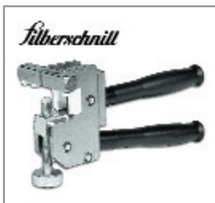
Цельнометаллический инструмент массивной конструкции предназначен для ломки толстого стекла толщиной 6-15 мм и до 25 мм. Возможность точной фиксации приспособления в соответствии с толщиной стекла. Оптимальное распределение усилия при резке стекла толщиной более 6 мм.
