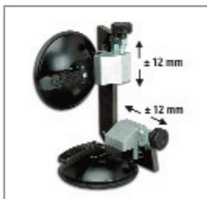
Длина полок 200 и 120 мм. Фиксирующее устройство из двух присосок (120 мм) со специальным уплотнителем, передвижение +/- 12 мм. Возможность точной регулировки. Направляющие изготовлены из алюминиевого сплава.
