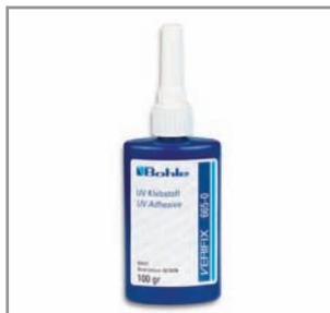
Отверждение осуществляется при воздействии ультрафиолетовых лучей. Жидкий и прозрачный, обладает хорошими капиллярными свойствами. Этот клей специально предназначен для склейки поверхности типа стекло/стекло. Низкая вязкость 60 мПа, времясберегающая технология, не предназначен для использования во влажной среде, выдерживаемая нагрузка 23 н/мм<sup>2</sup>
