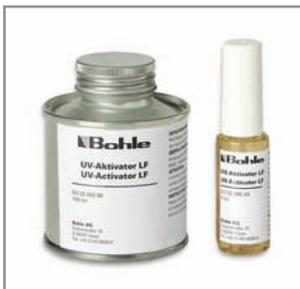
Этот активатор делает возможным затвердевание УФ-клея В-682-Т без облучения с помощью УФ-лампы. Получаемое при этом соединение менее устойчиво к нагрузкам по сравнению с соединением, затвердевшим под воздействием УФ-лучей.
