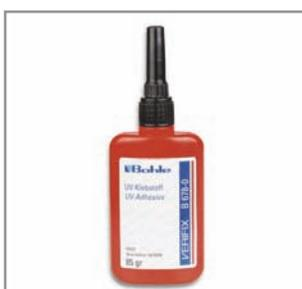
Отверждение этого клея осуществляется под воздействием ультрафиолетового излучения. Основные свойства: совершенно прозрачный и средней вязкости. Благодаря особой чувствительности к воздействию УФ, клей идеален для склейки триплекса со стеклом, триплексом, металлом, деревом, камнем, а также термопластом. Вязкость 600 мПа, выдерживаемая нагрузка 12 н/мм<sup>2</sup>
