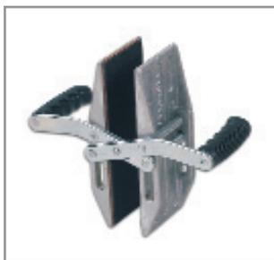
Устройство для переноски изготовлено из алюминия. Подходит для транспортировки всех материалов. Например, гипсокартонных плит и кухонных столешниц. Чем тяжелее груз, тем сильнее действие зажимов. Максимальная толщина переносимого груза 40 мм. Подъемный вес (при использовании 2 зажимов) 160 кг. На заказ Вы можете получить нестандартные модели для переноски грузов толщиной 60-80 мм и 85-100мм.
