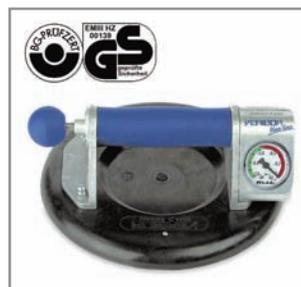
Надежная присоска с большим подъемным весом для переноски тяжелых грузов из таких материалов, как стекло, пластмасса, металл, обработанное дерево или мрамор. Высокая надежность достигается за счет того, что Вы следите за состоянием вакуума. Подъемный вес: 120 кг, для горизонтальной переноски грузов.
