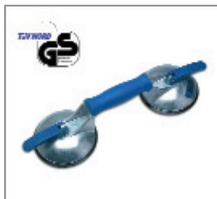
Присоска предназначена для транспортировки таких материалов, как стекло, пластмасса, металл, обработанное дерево с покрытием и мрамор. Знаки безопасности TUV/ GS. Подъемный вес 60 кг, для горизонтальной переноски грузов.
