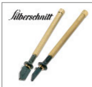
Сменная режущая головка. Твердосплавный режущий ролик, угол заточки которого равен 135°. Расстояние между краем линейки и режущим роликом 2,5 мм. Модель из латуни с резиновой опорной манжетой. Поворачивающаяся на 30° режущая головка.
