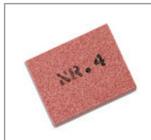
Посредством интенсивного сверления при помощи заточного камня между алмазными зернами образуются новые впадины, которые обеспечивают высокое качество резки. Если же после заточки Вы не достигли желаемых результатов, то лучше всего использовать фуговальный камень.
