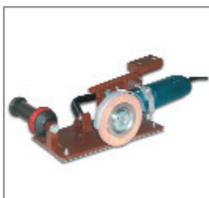
Для стеклянных полотен с прямыми краями. Направляющая пластина с подвижным скользящим упором. Усилие при шлифовке регулируется с помощью передвигаемого грузика. Ручная подача. Для использования с шлифовальным диском. Технические данные: Макс. 3000 об./мин. 600 Вт. 230 В / 50 Гц.
