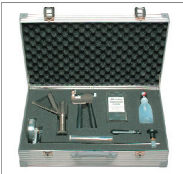
Набор инструментов для резки толстого стекла в алюминиевом чемодане. В чемодане собраны все необходимые инструменты для проведения прямолинейной резки и резки по кругу. Толщина стекла до 25 мм, макс. диаметр 120 см. Новинка: теперь в поставку входит масляный стеклорез BO 2000.P Пауер и алюминиевый чемодан.
