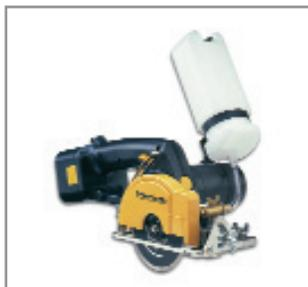
Для распила ламинированного стекла толщиной до 16 мм. Подаваемая вода связывает стеклянную пыль. Установка угла пиления от 0° до 45°. Частота вращения без нагрузки: 0 – 3200 об./мин. Диаметр установочного отверстия диска – 20 мм. Объем поставки включает: одно устройство EY0202 для ускоренной зарядки аккумуляторов, набор аккумуляторов EY9001B на 12 В, один режущий диск с алмазным покрытием диаметром 110 мм, один резервуар для воды, один ключ с внутренним шестигранником.
