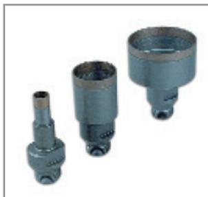
Для типичного использования, наружная резьба R 1/2" (Continental), длина 75 мм. Основной материал: сталь, покрытая защитным слоем лака, алмазный слой из спекшегося материала. Перед первым использованием сверла следует затачивать.
