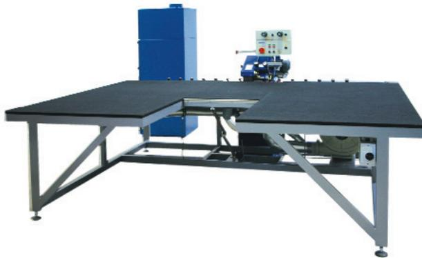
При машинной обработке стекла необходимы качественные высокоточные приборы, чтобы избежать повреждений чувствительного материала. Фирма Bohle разработала высокоэффективный шлифовальный двухленточный станок для сухой шлифовки прямоугольной кромки, который незаменим при обработке стекол с чувствительным к влаге покрытием. При работе со столом на воздушной подушке от Bohle создается шлифовальный центр для эффективной и бережной обработки стекла с высочайшим качеством кромки.
