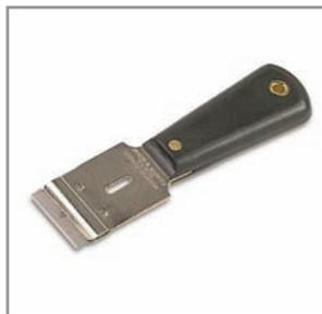
Металлический. С защитным чехлом для лезвия. С пластмассовой ручкой. Сменные лезвия. Ширина - 40 мм. Для снятия засохших остатков клея с поверхности стекла, в т.ч. из труднодоступных углов.
