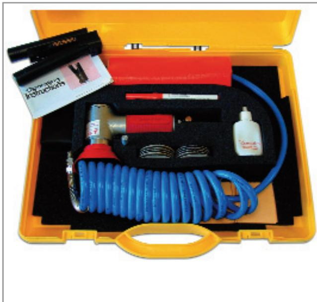
Без особых усилий и незаметно это устройство позволяет устранить царапины с поверхности стекла. Идеально подходит для использования в автомобильной и мебельной промышленности (например, стеклянные столешницы), в области производства мебели для ванных комнат (зеркала и душевые кабины). Несложное управление с полировочным диском.
