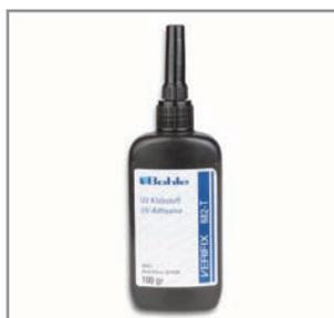
Отверждение осуществляется при воздействии ультрафиолетовых лучей. Средняя вязкость, относительно густой. Благодаря новому составу, клей теперь совершенно прозрачный. Специально разработан для склейки поверхностей типа стекло/металл. Можно использовать с активатором В-953-0(BO 52 093 03). Вязкость 900 МикроПаскаль. Выдерживаемая нагрузка 25 н/мм<sup>2</sup>
