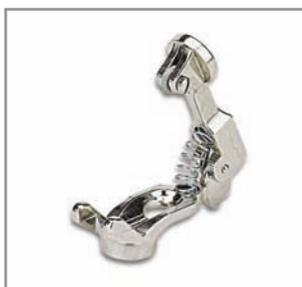
Никелированный. С твердосплавным режущим роликом. Для резки стеклянных трубок диаметром 4 - 30 мм. Угол заточки - 90°.
