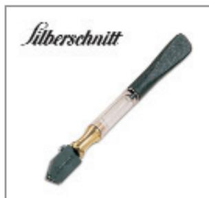
Широкая сменная режущая головка. Высококачественный твердосплавный режущий ролик, угол заточки 135°. Расстояние между краем линейки и режущим роликом 2,5 мм. Пластмассовая модель с прозрачным корпусом. Нижняя часть рукоятки выполнена из латуни. Традиционная форма.
