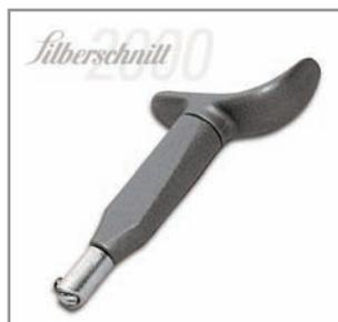
Рукоятка выполнена из надежной пластмассы, режущий ролик следует за движениями вашей руки, угол заточки режущего ролика 158°, для стекла толщиной до 25 мм, поворачивающаяся рукоятка для передачи высокого давления, расстояние до края линейки 6 мм
