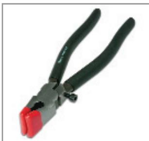
Щипцы для разлома стекла толщиной от 3 до 5 мм. Длина 200 мм, ширина губок 24 мм, с регулировочным винтом, середина отмечена красным цветом. Щипцы отлично подходят для обламывания узких стеклянных полос.
