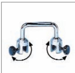
Две поворачивающиеся на 360°, вилкообразные направляющие изготовлены из алюминия и соединены между собой. На них закреплены два пластмассовых винта, посредством которых стекло фиксируется. Идеально подходит для изготовления аквариумов.
