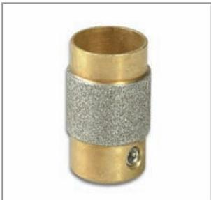
Этот алмазный инструмент подходит к станкам для шлифовки стекла любых изготовителей. В сочетании с адаптером H11 эти цилиндрические шлифовальные головки могут применяться на стандартных сверлильных станках.
