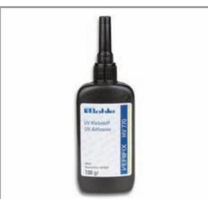
Затвердевает при УФ облучении и при дневном свете. Обладает высокой вязкостью и по этой причине способен заполнять небольшие щели шириной до 0,9 мм. Важными особенностями являются прозрачность соединения, долгосрочная несклонность к пожелтению и высокая влагостойкость. Клей после засыхания твердый и ломкий. Вязкость от средней до высокой. Стекло/стекло и стекло/металл.
