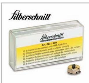
Сменная розетка содержит твердосплавные режущие ролики диаметром 5 мм, угол заточки 135°, для стекloreзов 400.0 и 410.0
