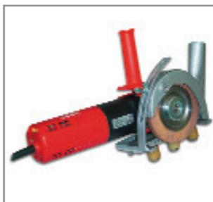
Ручной инструмент для снятия LOW-E слоя с края стекла. Для стекла с прямыми или фигурными краями. Ведение по краю стекла с помощью упорных роликов. Ручное усилие при шлифовке. Для использования со специальным шлифовальным диском. Технические данные 1200 - 3700 об./мин. 1200 Вт. 230 В / 50 Гц.
