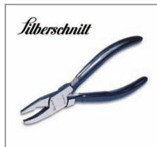
Длина 160 мм. Ширина губок 4 мм. Ручки с искусственным покрытием. С отшлифованной головной частью. С возвратной пружиной для открывания губок. Особенно удобны для работы с художественным стеклом. Небольшая площадь контакта. Достаточно небольшого усилия. Уменьшают риск поломки стекла.
