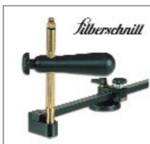
Это идеальный стеклорез-циркуль, применяемый с масляными стеклорезами 2000S, М или Р. Вы добиваетесь превосходных результатов резки стекла благодаря следующему за движениями вашей руки режущему ролику, изготовленному из высококачественного материала Torlife, и встроенному механизму подачи жидкости для резки. Масляный стеклорез и поперечная ручка в поставку не входят.
