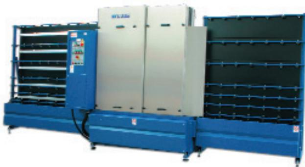
Новая серия машин для мойки стекла представлена 6 моделями, которые предназначены для стекол толщиной от 3 до 12 или до 20 мм. Устройства помимо прочего отличаются высотой мойки, количеством щеток и числом моющих камер. Все машины открыты сверху, что позволяет мыть стекла высотой до 3.20 м, а это вдвое больше высоты моющей камеры. Центральный блок для мойки и сушки, а также емкость для очистки воды изготовлены из нержавеющей стали. Мощный вентилятор гарантирует сухость чистого стекла.
