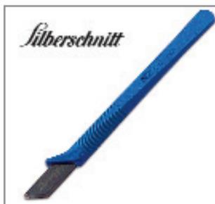
Режущие ролики изготовлены из высококачественного материала. Пластмассовая, удивительно легкая рукоятка. Можно использовать для ломки стекла. Мягкий и легкий ход. Универсальный стеклорез для резки стекла толщиной от 2 до 12 мм. Угол заточки режущего ролика 135°. Несменяемые режущие ролики. Расстояние между краем линейки и режущим роликом 2,5 мм
