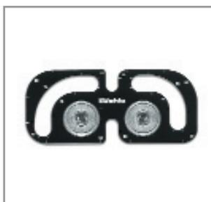
Шаблон имеет 2 присоски для надежного закрепления на стекле. Для вырезки радиусов от 10 до 70 мм. Для применения со стеклорезами 2000.М, 2000.Р или 2000.С. Расстояние между режущим роликом и краем шаблона 6 мм.
